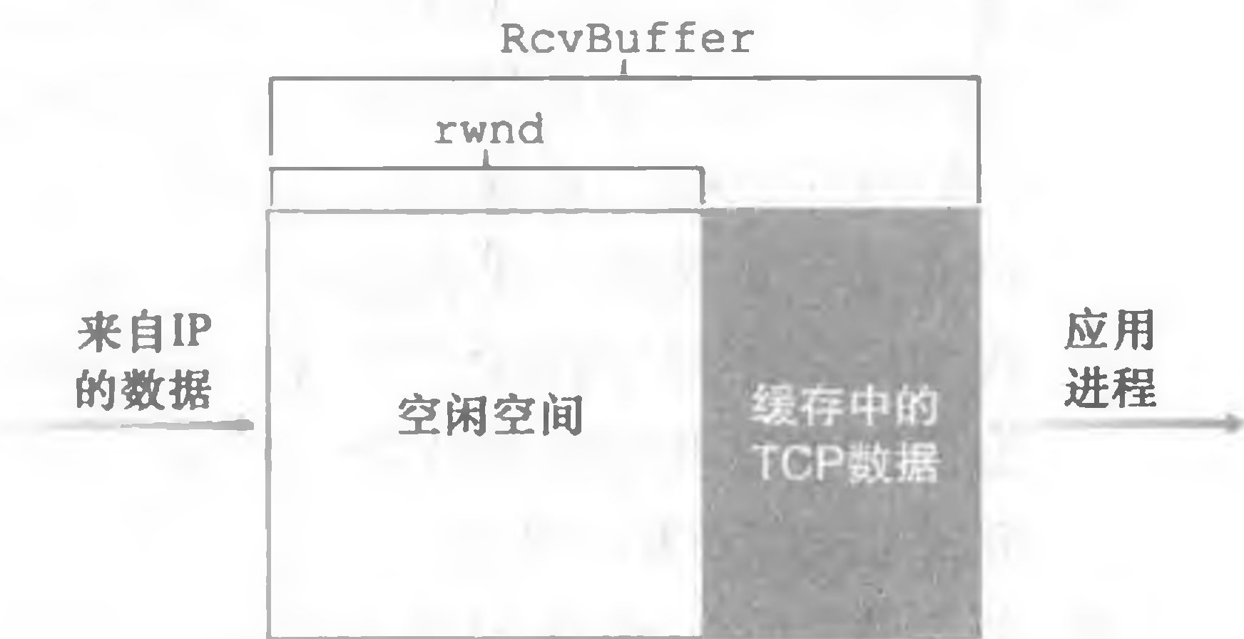
图 3-38 接收窗口 (rwnd) 和接收缓存 (RcvBuffer)
