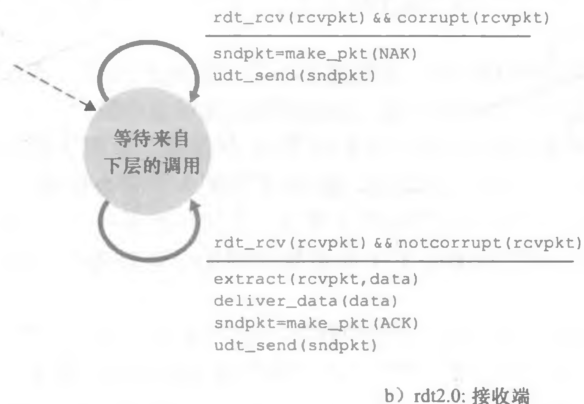
图 3-10 rdt2.0: 用于具有比特差错信道的协议
