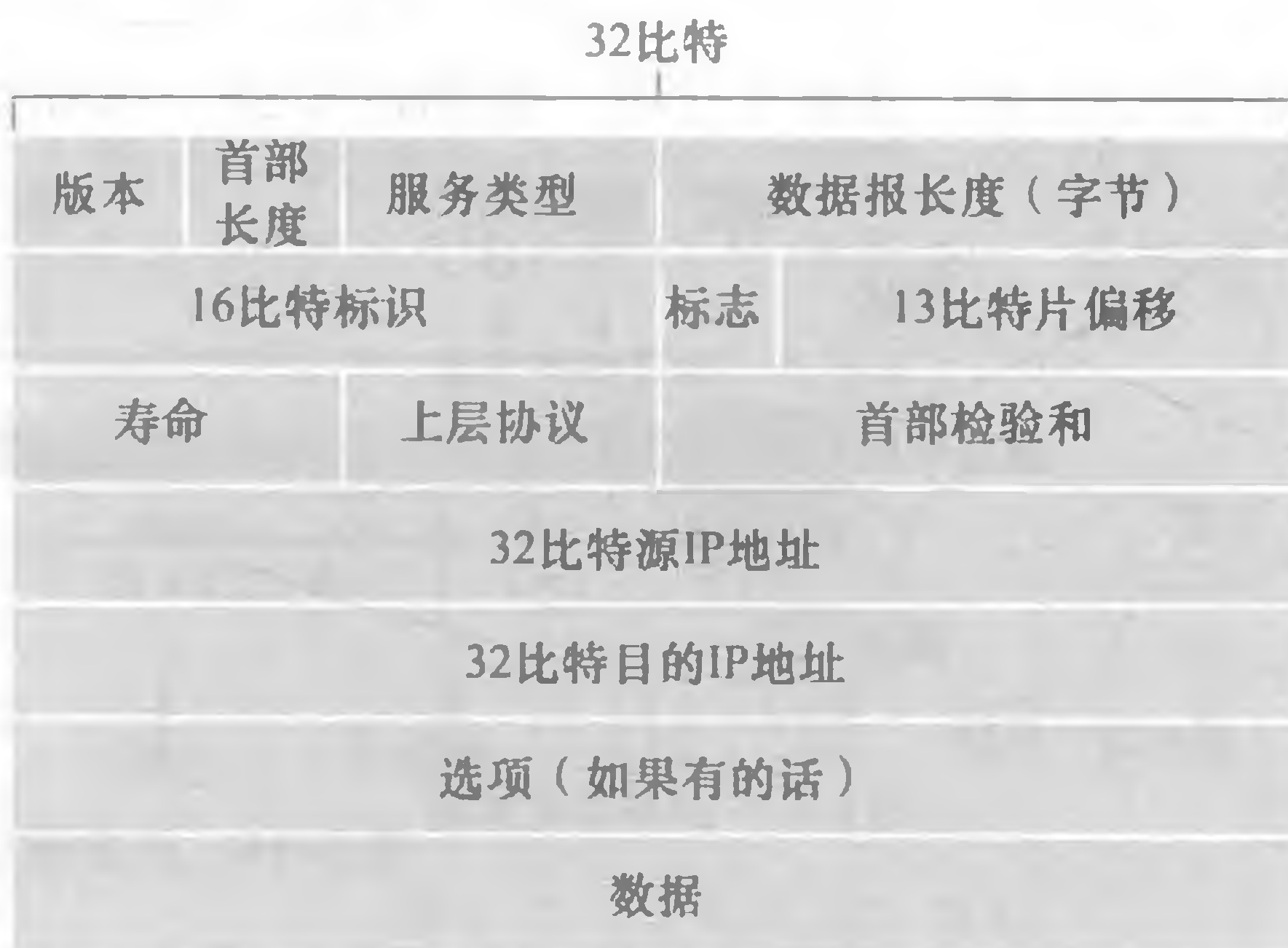
图4-16 IPv4数据报格式
