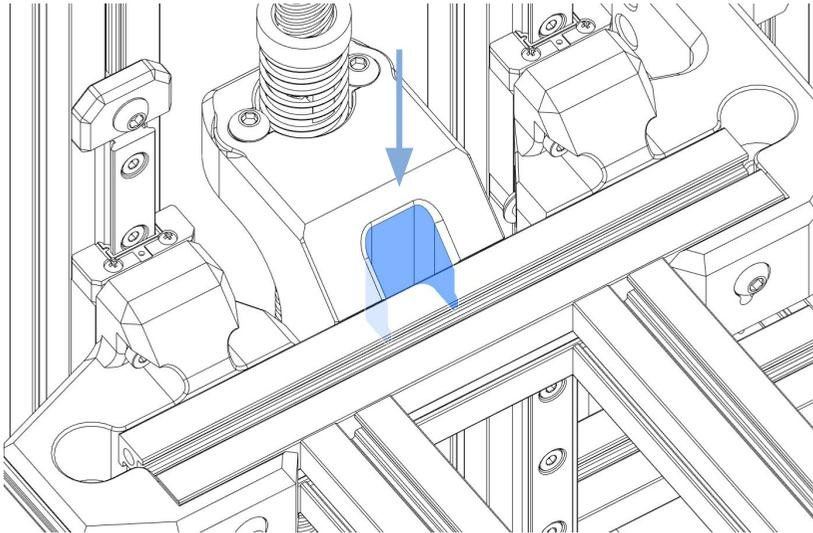
**PATH FOR HEATER WIRES**
