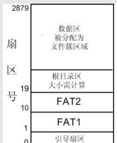
Fig 2.11: FAT 檔案系統存儲結構圖
