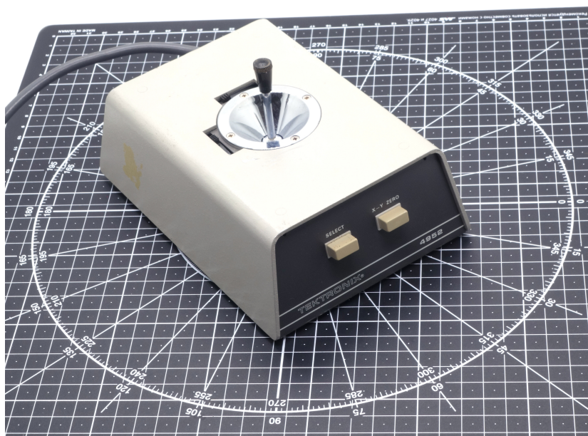
Рис. 3: Джойстик Tektronix 4952 на размерном коврик с шагом сетки 1 см
