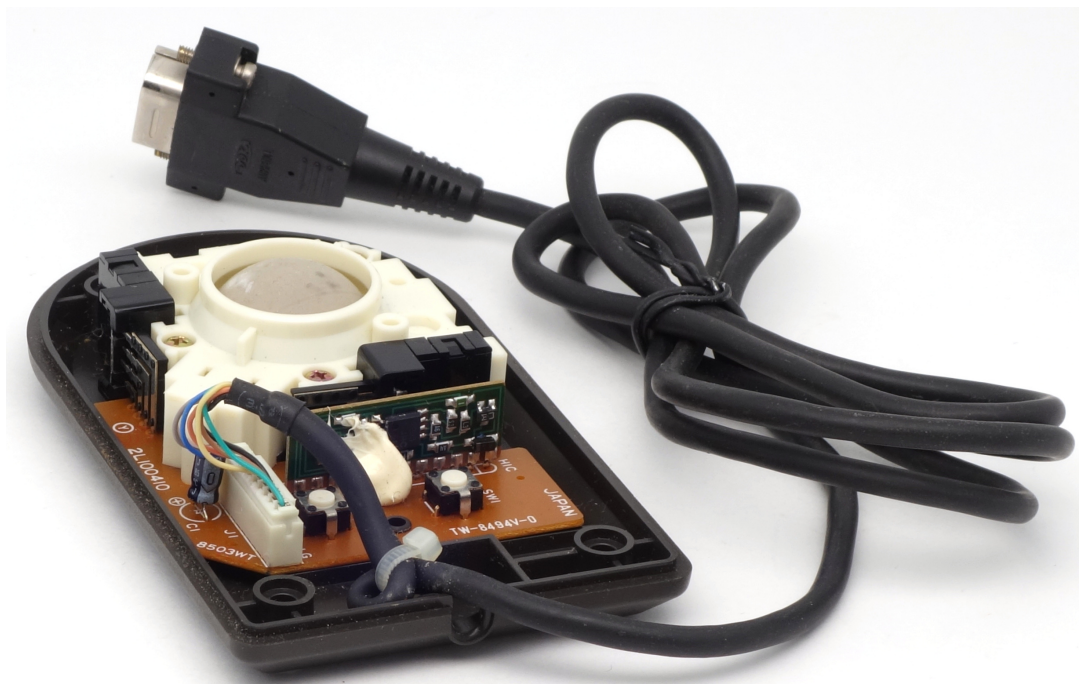
Рис. 5: Siemens PC-D Mouse в разобранном состоянии
