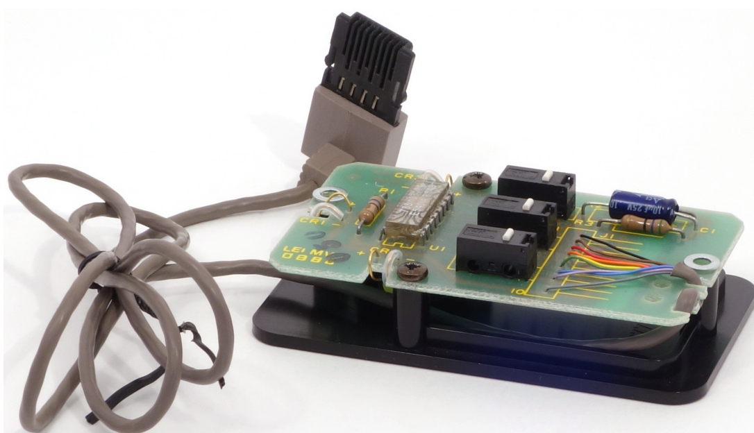
Рис. 6: Xerox AI Mouse в разобранном виде
