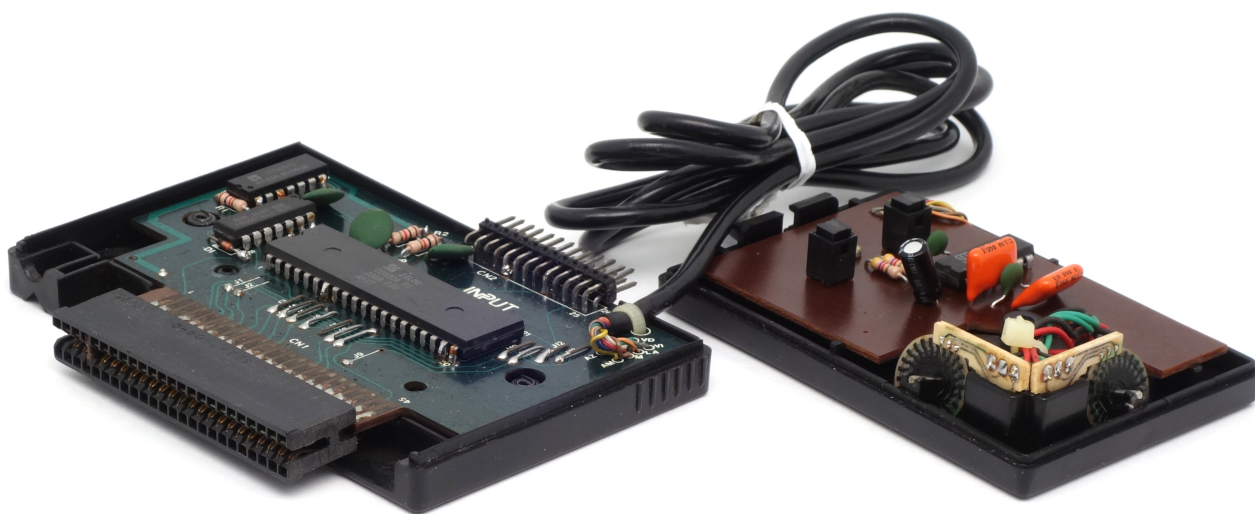
Рис. 5: TPX Mouse в разобранном виде
