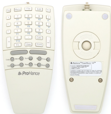
Рис. 2: Изображение ранней версии Prohance PowerMouse 100, вид сверху и снизу
