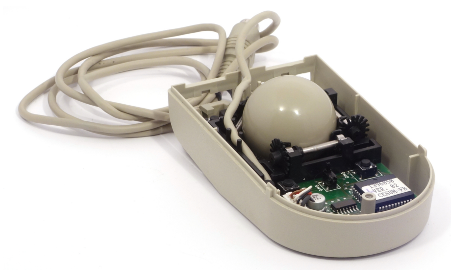
Рис. 6: Изображение BM PS/2 Track Ball изнутри
