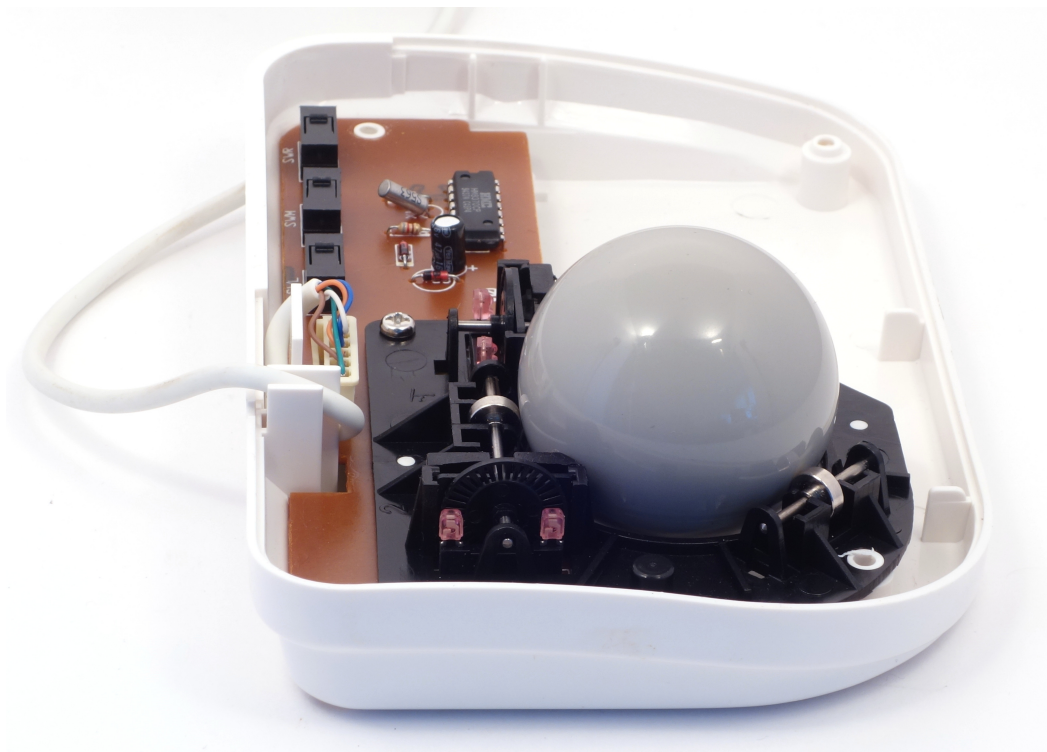
Рис. 5: Мемогех в разобранном виде
