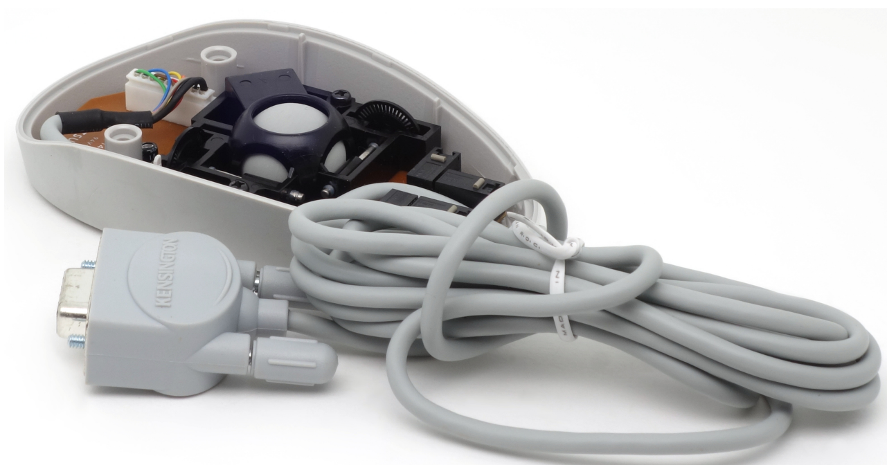
Рис. 5: Изображение Thinking Mouse в разобранном виде
