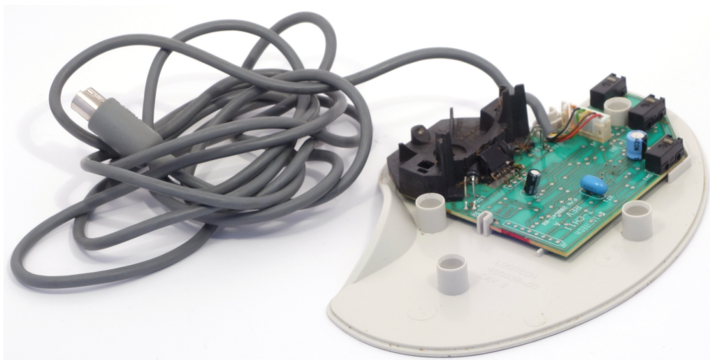
Рис. 5: Изображение Logitech TrackMan изнутри
