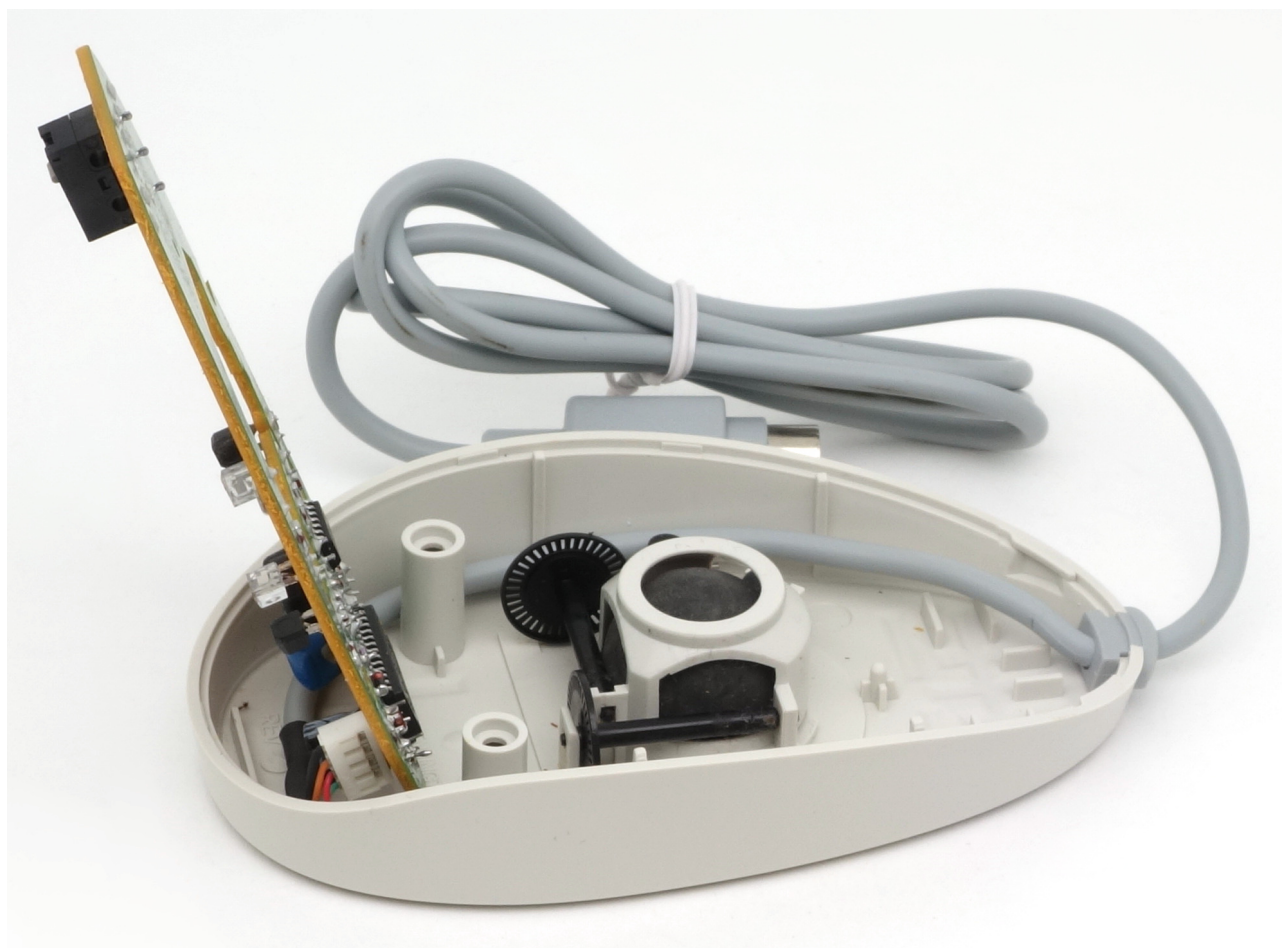
Рис. 5: Изображение Kensington Mouse второго поколения в разобранном виде
