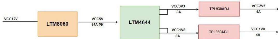
图 30 AXRF67 载板电源接口部分
