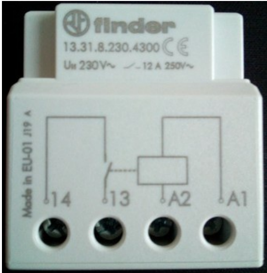
Ein übliches Koppelrelais. Die entsprechenden Pins am Mikrocontroller werden bei diesem Modell an "14" und "13" angeschlossen.
