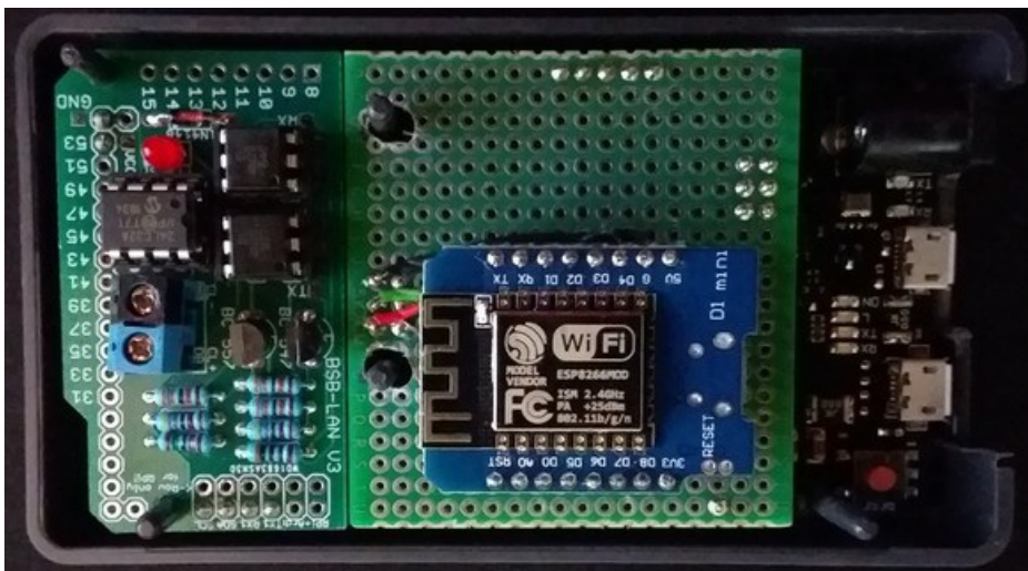
Wemos D1 auf einer Lochrasterplatine auf dem Arduino Due.
