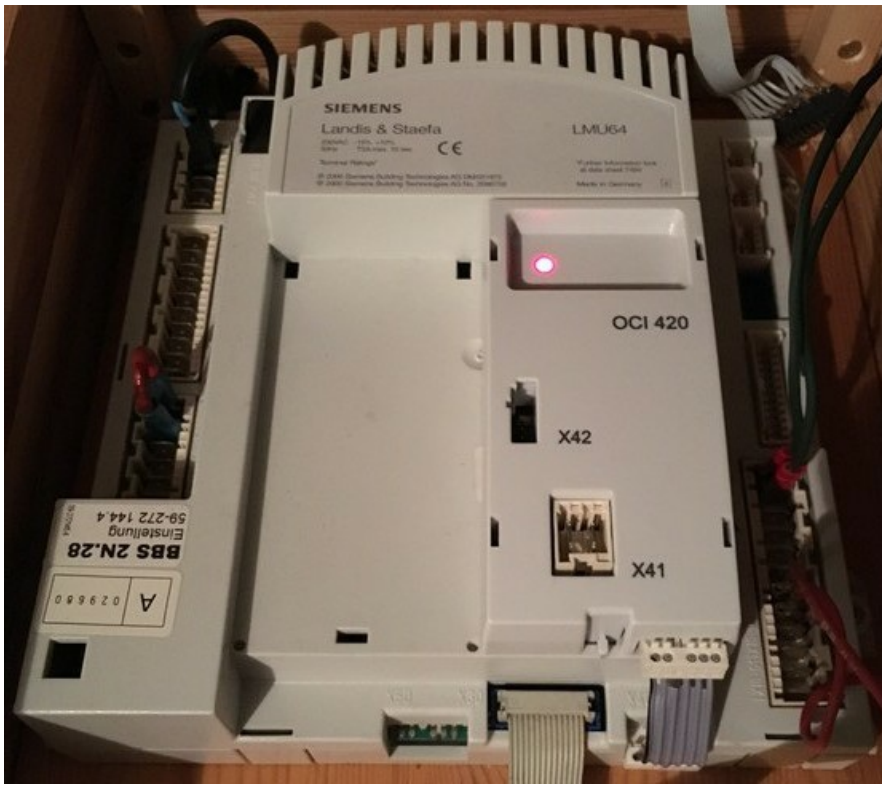
Ein Regler des Typs LMU64 samt installiertem OCI420 ClipIn-Modul.
