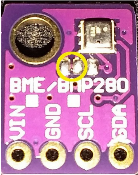
Adresse 0x76: Leiterbahn zwischen dem linken und dem mittleren Lötunkt.
