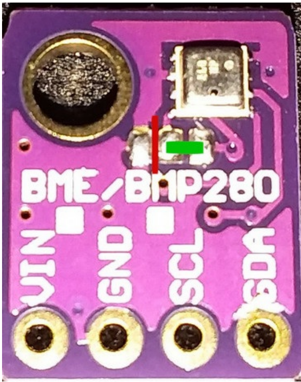
Adresse 0x77: Die rote Linie markiert die durchgetrennte Leiterbahn, die grüne Linie markiert die neu herzustellende Verbindung.
