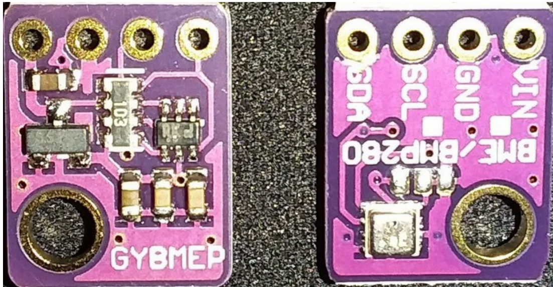
Ein BME280-Sensor auf einem typischen Breakout-Board (Clone); links = Vorderseite, rechts = Rückseite.
