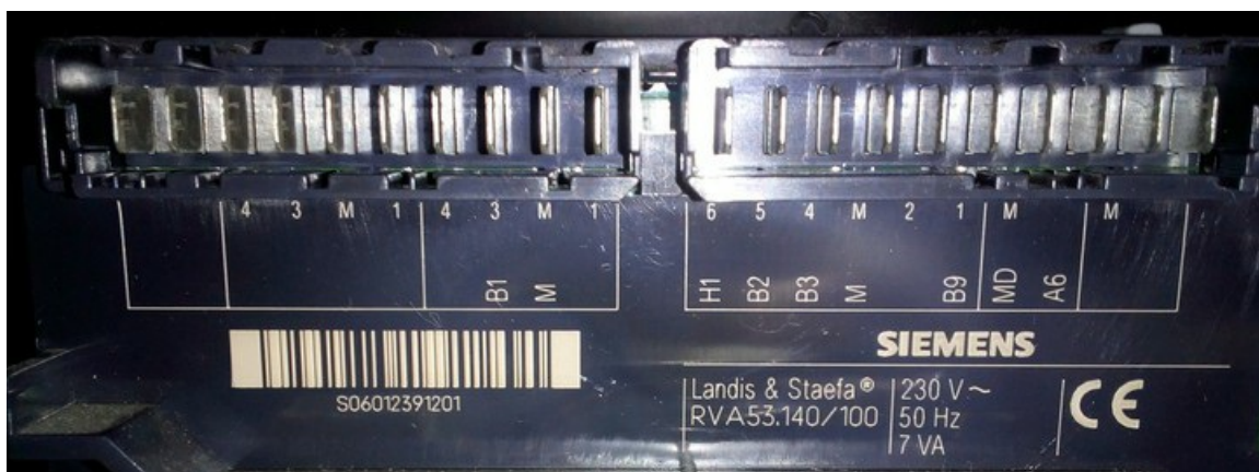
Die Anschlüsse "A6" und "MD" bei einem Siemens RVA53 Regler.
