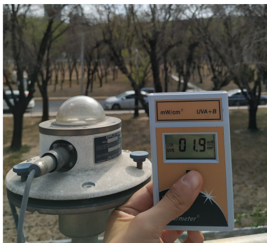
Figura 4.3: Piranómetro de la estación Centro del SIMA (izquierda) y radiómetro UVA+UVB (derecha).
