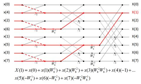
其中输入点列按位反转(Bit Reversal)排序:首先依据二进制进行编号,然后对各个编号按位倒置并按此重新排序。例如,对于一个8点变换:
