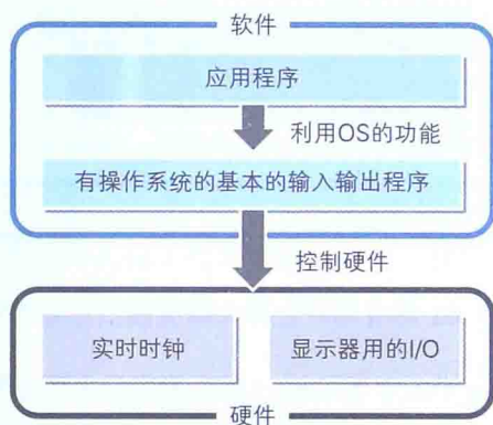
图 9-5 应用程序经过 OS 间接地控制硬件
