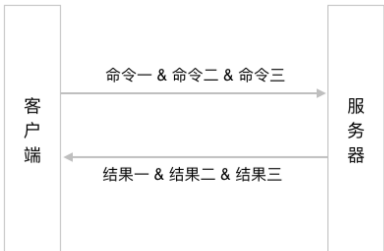
图 13-2 在使用流水线的情况下执行三个 Redis 命令产生的网络通讯操作
