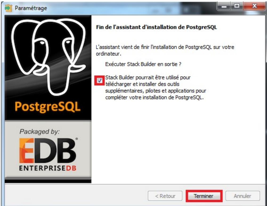
L'installation est terminée. Si vous souhaitez installer des modules complémentaires (phpPgAdmin, Slony...), lancez l'outil Stackbuilder. Il nécessite une connexion à internet.
