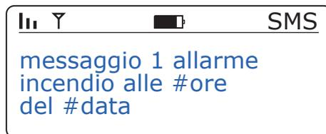
**#ore** e **#data** sono parole speciali che permettono a NANO-SMS di inserire l'ora e la data dell'evento di allarme nel messaggio SMS.
