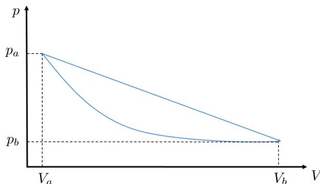
Un gas ideal monoatómico pasa por dos procesos. El proceso inicia con el gas a una presión  $p_a$  y volumen  $v_a$  conocidos, y se expande hasta un volumen  $V_b$  también conocido, siguiendo la línea recta que se representa en el diagrama  $p - V$  (Presión-volumen). Posteriormente el gas se comprime hasta volver a su volumen inicial siguiendo un proceso isotérmico.
