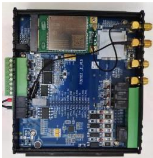
OCPP 控制板 正面
