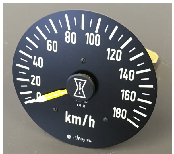
Abbildung 3.3: geöffneter Geschwindigkeitsanzeiger der MFA 1/2n
