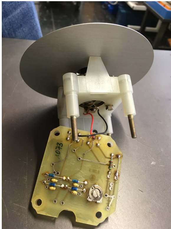
Abbildung 3.4: modifizierte Leiterkarte im Geschwindigkeitsanzeiger der MFA 1/2n
