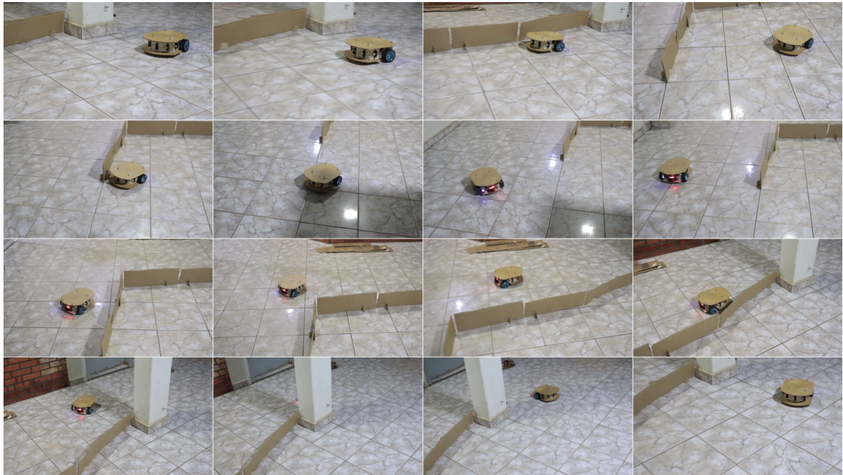
Figura 49 – Resultado do comportamento “Seguir Parede”
