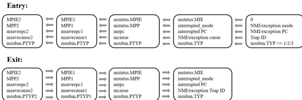
图 4-4 N200 系列内核两级 NMI/异常状态堆栈机制示意图
