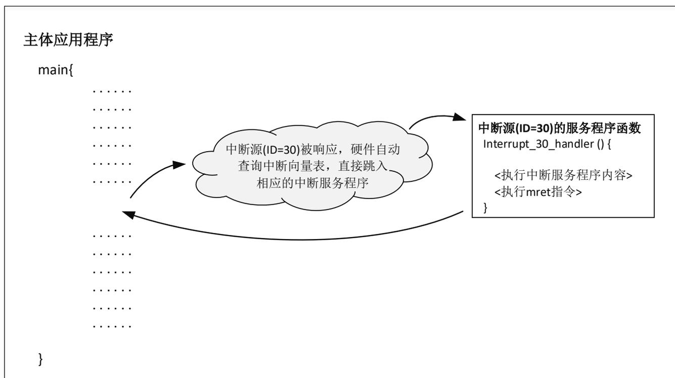
图 5-12 中断的向量处理模式示例
