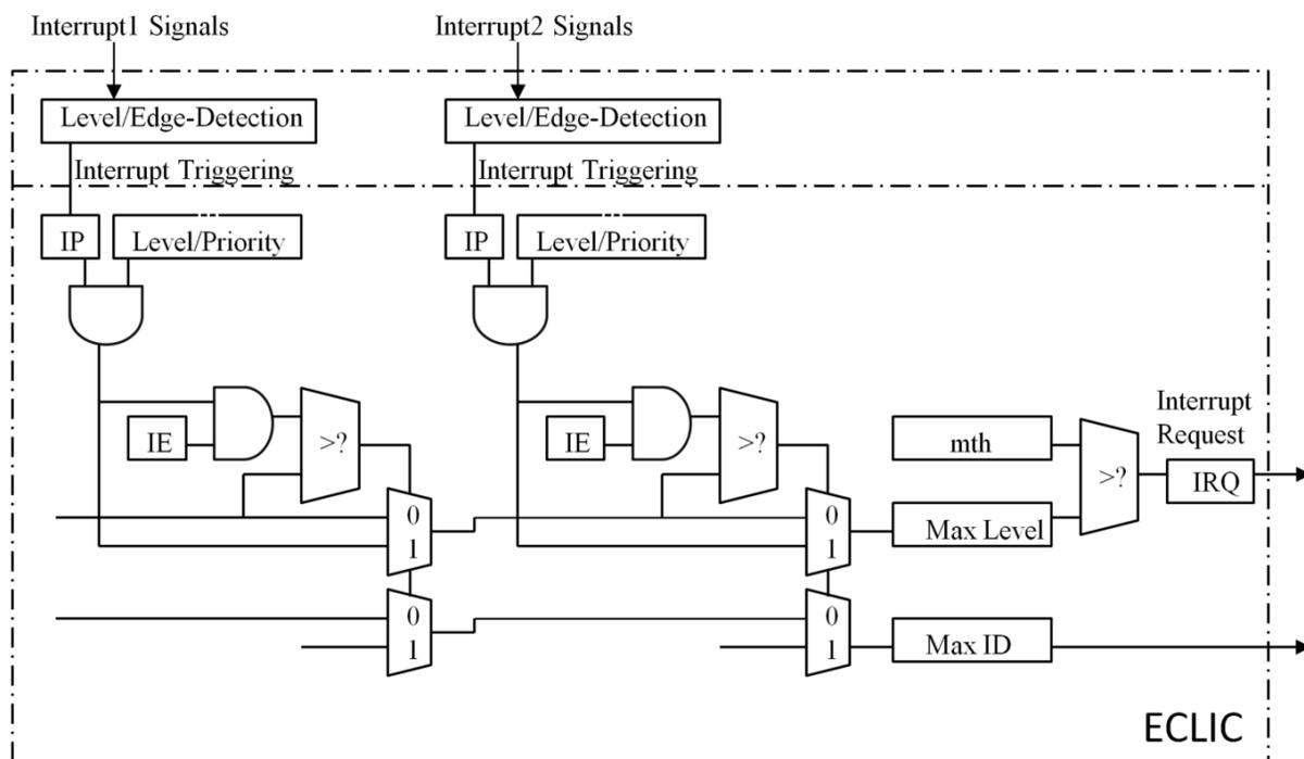
图 6-1 ECLIC 逻辑结构示意图
