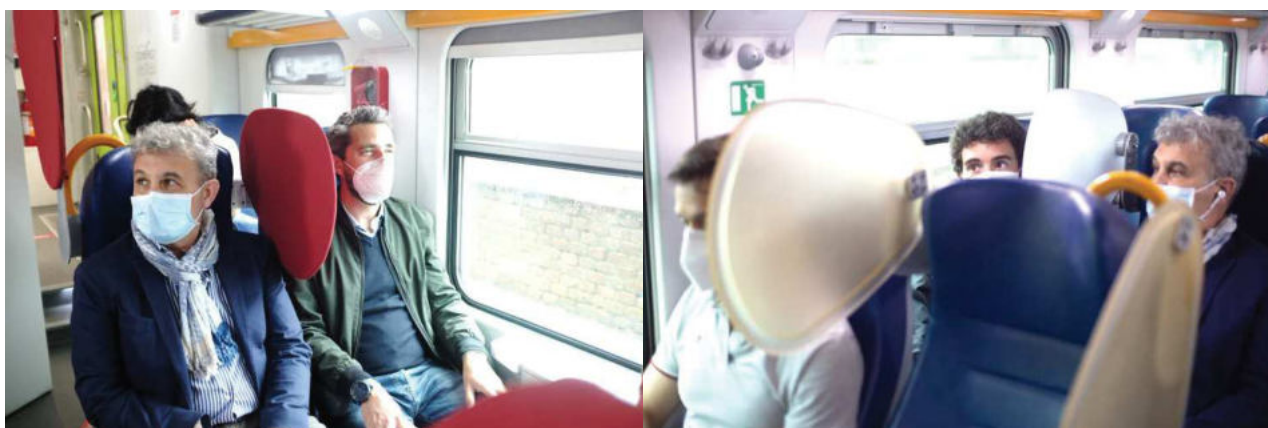
Fig. 4 Prototipi finali di barriere fisiche sviluppate nel corso del progetto. Test in ambiente operativo: valutazione di esperienza d'uso condotta su treno in movimento in presenza di passeggeri.
