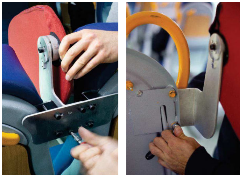
Figura 1.3: Sistemi di fissaggio centrale (sx) e corridoio (dx)
