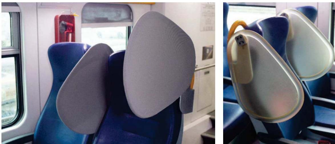
Figura 1.1: Paratie regolabili in altezza e in ingombro
