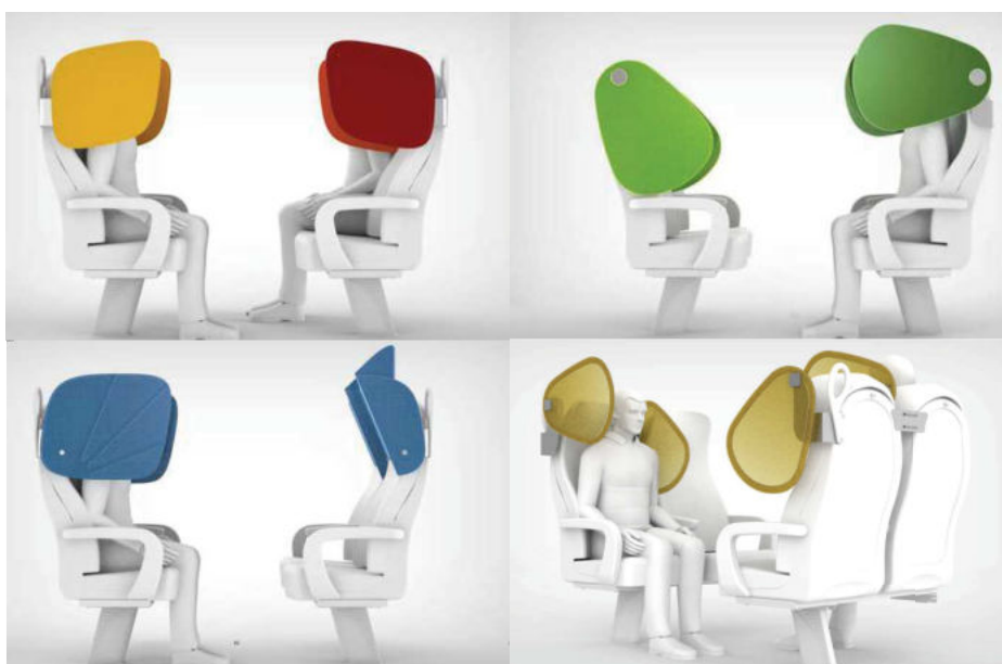
Fig. 1 Esempi di concept design delle barriere fisiche sviluppate nel corso del progetto: barriera fissa di materiale resiliente (in alto a sinistra), barriera mobile in materiale plastico semitrasparente (in alto a destra), barriera mobile in materiale tessile (in basso a sinistra), barriera ripiegabile ad origami (in basso a destra). Tutti i concept prevedono l'impiego di materiali di copertura con proprietà virucide.
