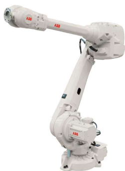
شکل ۲-۰- ریات irb4600 از شرکت abb برگرفته از مرجع [۱۲].
