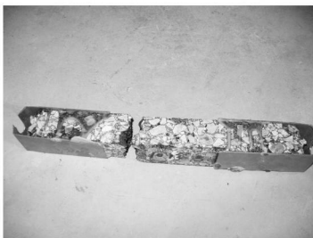
图 6 拉伸破坏后的试件
