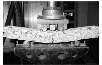
图 10 疲劳试验性能 破坏后的试件
