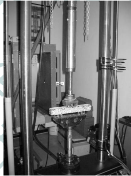
图 9 试件的疲劳性能试验 通过 MTS 机加载
