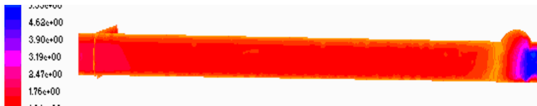
图 7 隧道轴向速度分布云图（短道长度 X=60\text{m} ）
