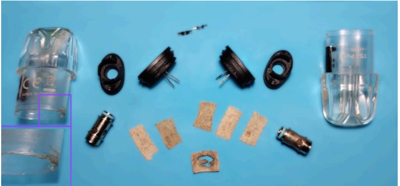
Due TSX pod disassemblati il cui interno è presentato su un tappetino di silicone
