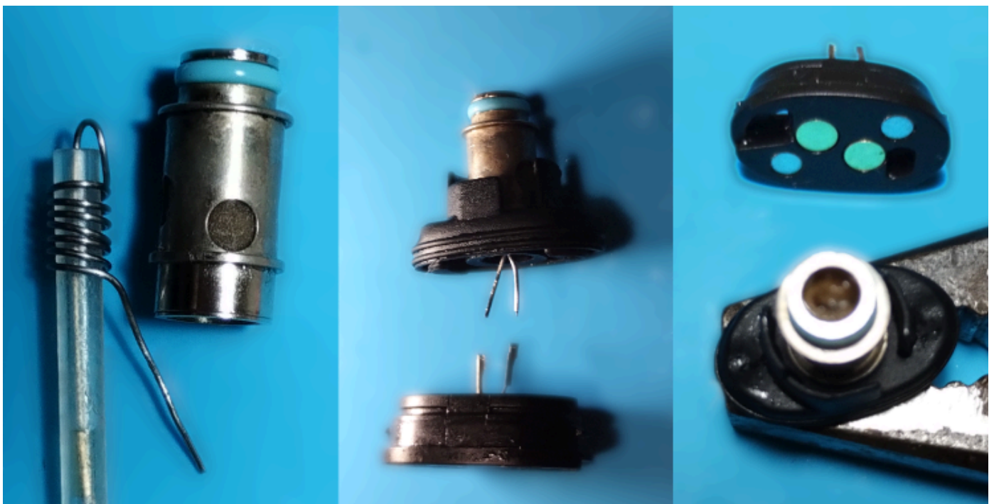
Risultato della prima prova di ricostruzione della coil interna al TSX pod
