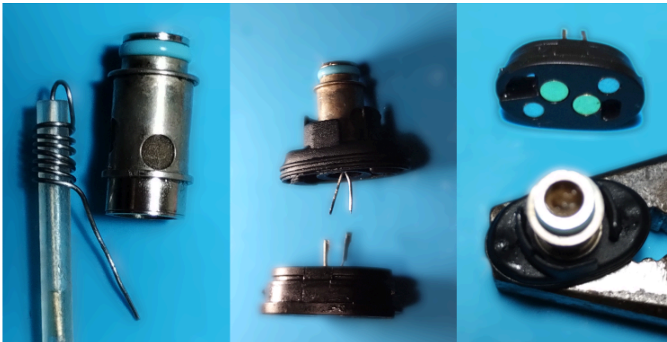
Risultato della prima prova di ricostruzione della coil interna al TSX pod
