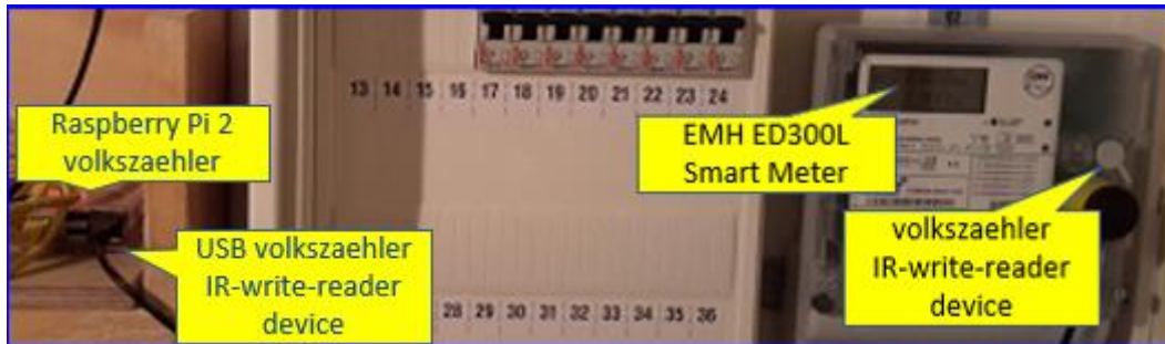
Volkszaehler Hardware setup
