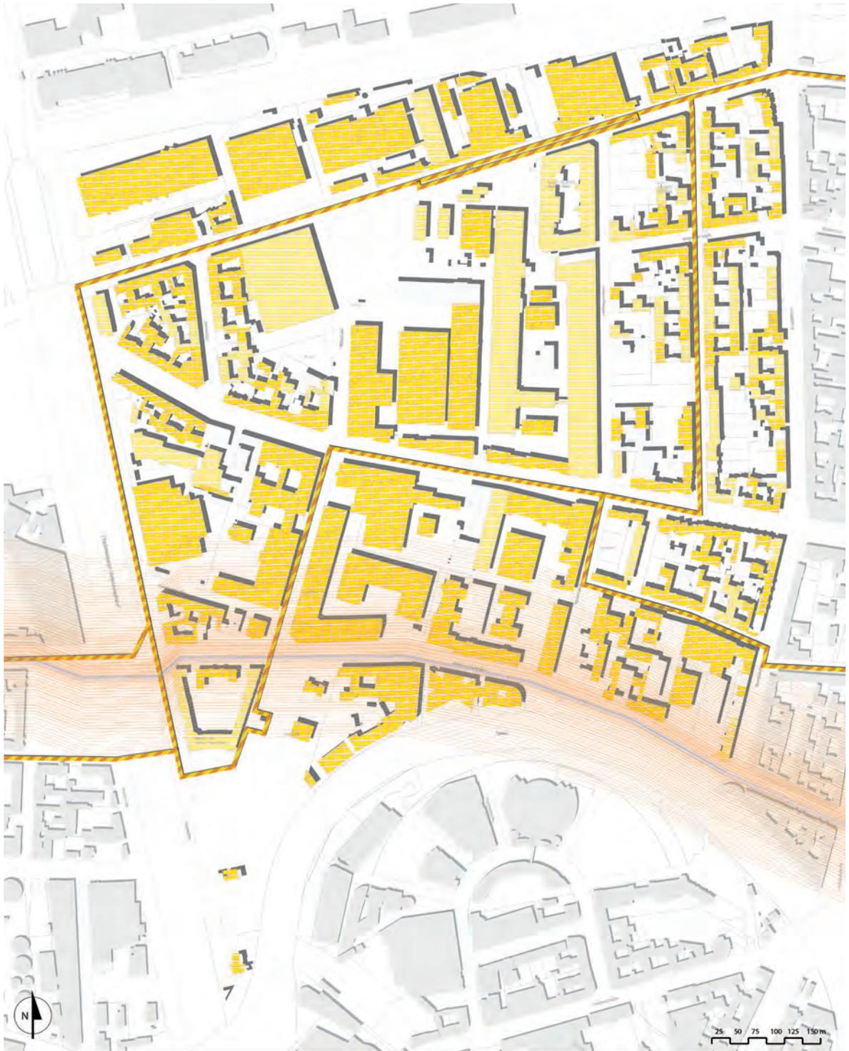
Abb. 4.7: Fernwärmeleitungen in Moabit West und Potenzial der Dachflächen zur solaren Energiegewinnung
