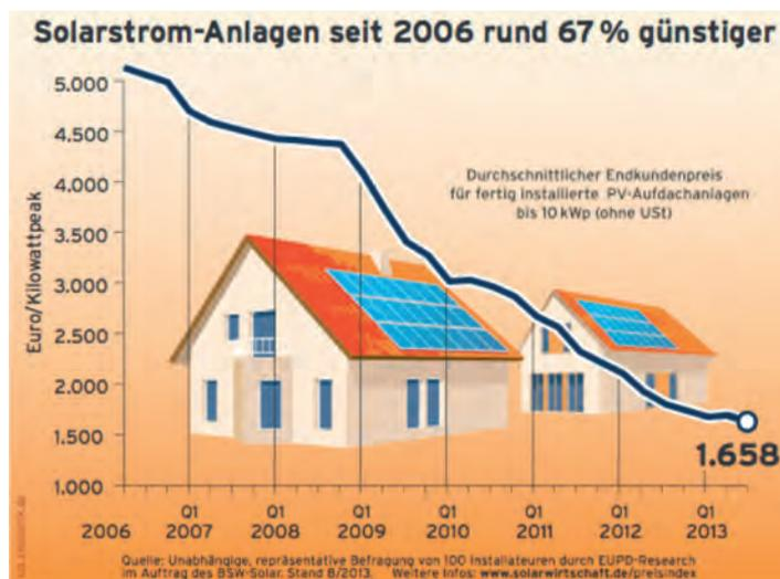
Abb. 4.8: Entwicklung der Gestehungskosten von Photovoltaikanlagen
