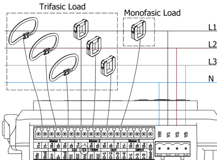
Ejemplo de conexión para una carga monofásica y trifásica, ambas configuraciones es posible alternarlas en los medidores. Con las sondas flexibles SenNet pre-calibradas es importante mantener el orden para conservar la Clase 1 en la medida.
