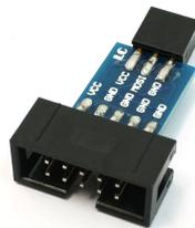
FIGURE 3 – L'adaptateur ISP 10 broches vers 6 broches
