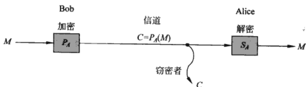
图 31-5 公钥系统的加密过程。Bob 使用 Alice 的公钥 P_A 来加密消息 M ，然后传送结果的密文 C = P_A(M) 给 Alice。一个截获传送的密文的窃密者无法得到关于 M 的信息。Alice 收到 C ，并且使用密钥来解密，以得到原始消息 M = S_A(C)
