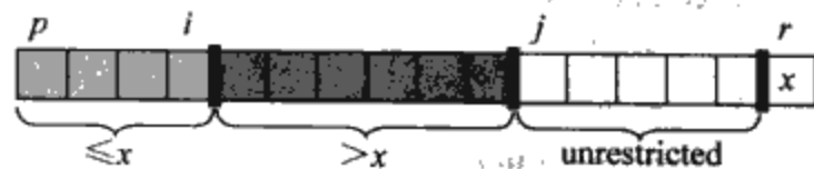
图 7-2 过程 PARTITION 作用于子数组 a[p..r] 后得到的四个区域。 A[p..i] 中的各个值都小于或等于 x ， A[i+1..j-1] 中的值都大于 x ， A[r]=x 。 A[j..r-1] 中的值可以取任何值
