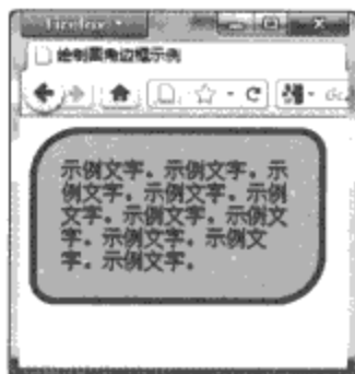
图17-13 在Firefox浏览器中使用两个半径参数的border-radius属性
