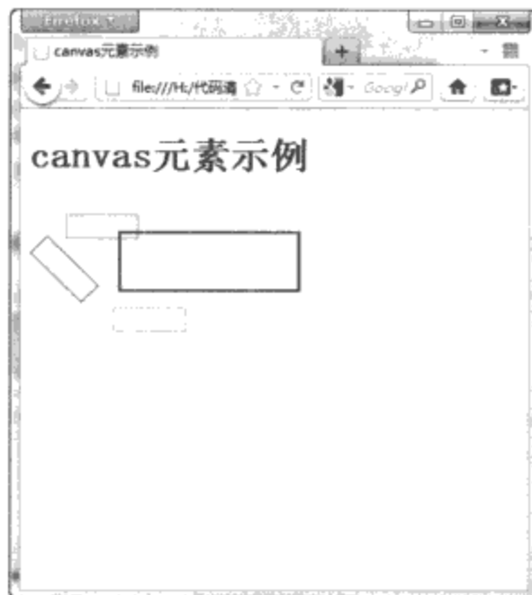
图5-13 使用setTransform方法绘制变形图形示例
