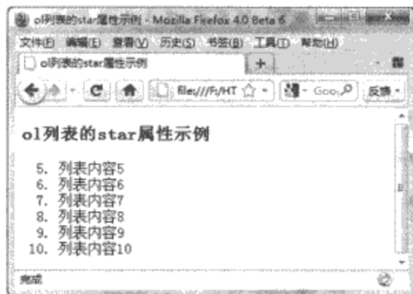
图4-25 ol列表的start属性示例
