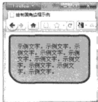
图17-17 绘制四个角不同半径的圆角边框
