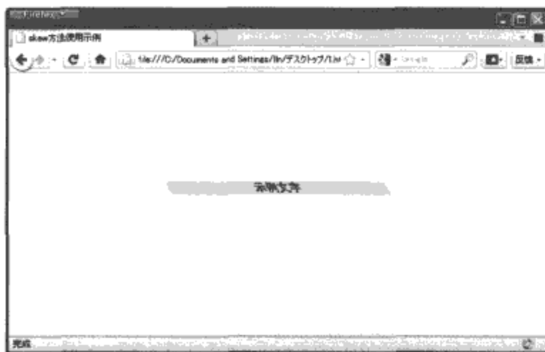
图18-5 skew方法中只使用一个参数
