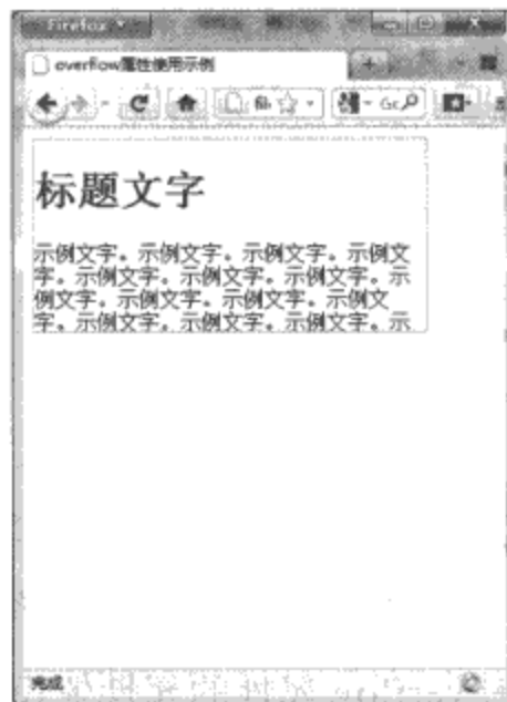
图16-20 overflow属性使用hidden属性值的示例
