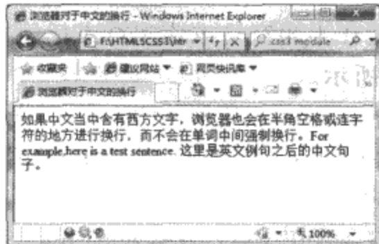
图15-9 Internet Explorer浏览器对于中文当中含有西方文字时进行换行的示例
