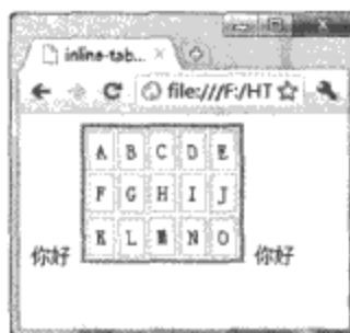
图16-13 在Chrome浏览器中inline-table类型元素的垂直对齐方式
