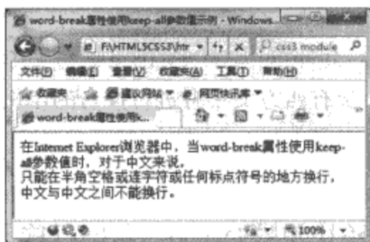
图15-11 Internet Explorer浏览器中word-break属性使用keep-all参数值的示例
