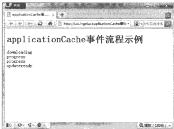
图8-4 applicationCache事件流程（再次打开网页且manifest文件已被更新时）
