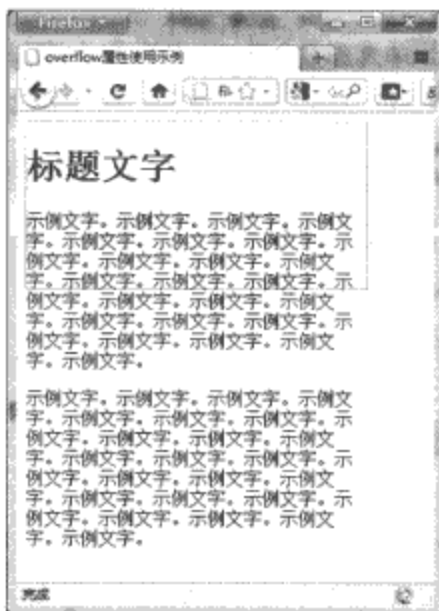
图16-23 overflow属性使用visible属性值的示例
