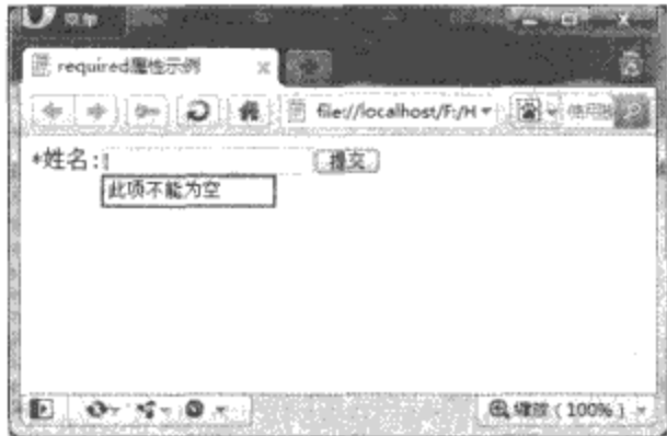
图4-14 Opera 10浏览器中的required属性检查示例 图4-15 Opera 10浏览器中的pattern属性检查示例
