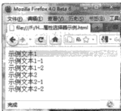
图13-1 使用CSS 2的属性选择器的示例
