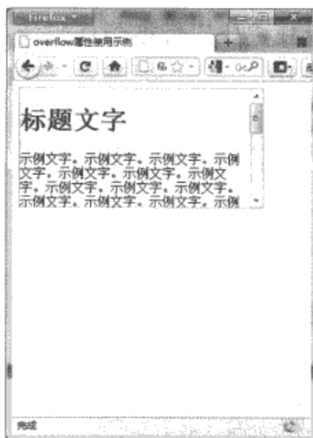
图16-22 overflow属性使用auto属性值的示例
