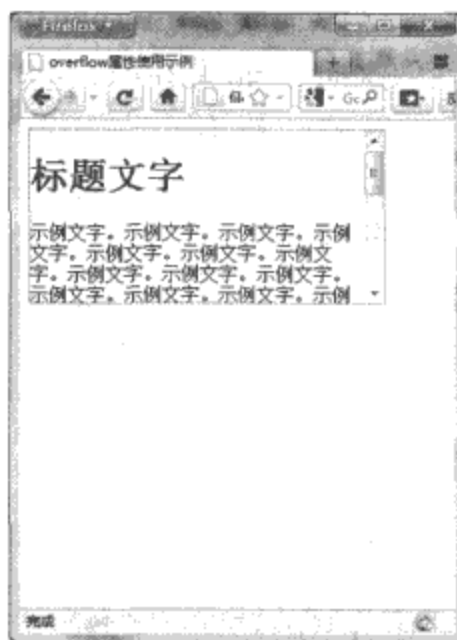
图16-24 overflow-x属性与overflow-y属性的使用示例
