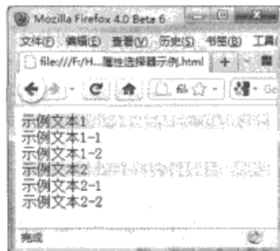
图13-3 使用[att^=val]属性选择器的示例
