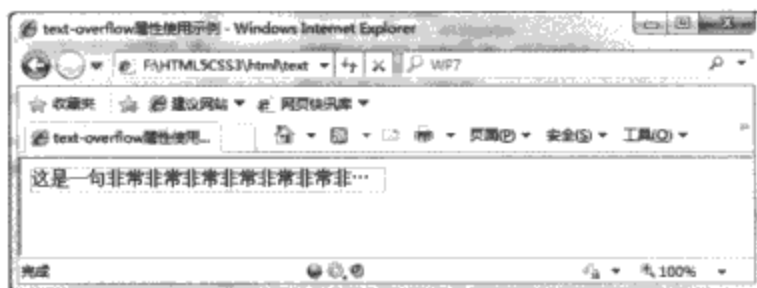
图16-27 text-overflow属性使用示例（在Internet Explorer浏览器中）
