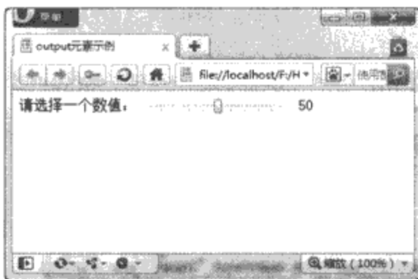
图4-13 output元素示例
