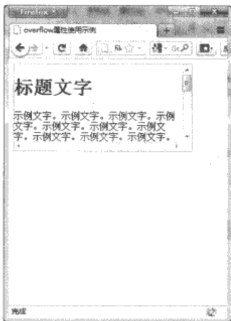
图16-21 overflow属性使用scroll属性值的示例
