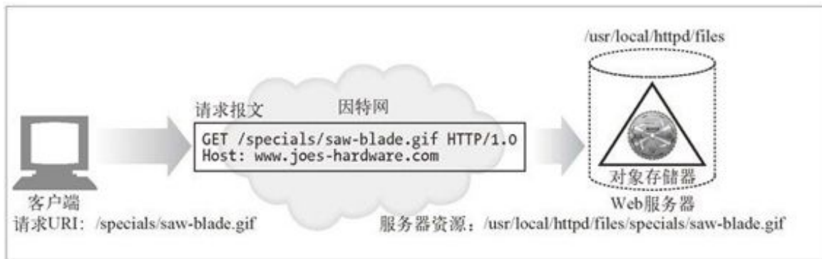
图 5-8 将请求 URI 映射为本地 Web 服务器上的资源
