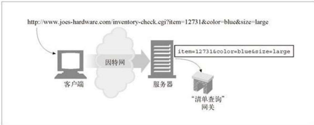
图 2-2 发送给网关应用程序的 URL 查询组件
