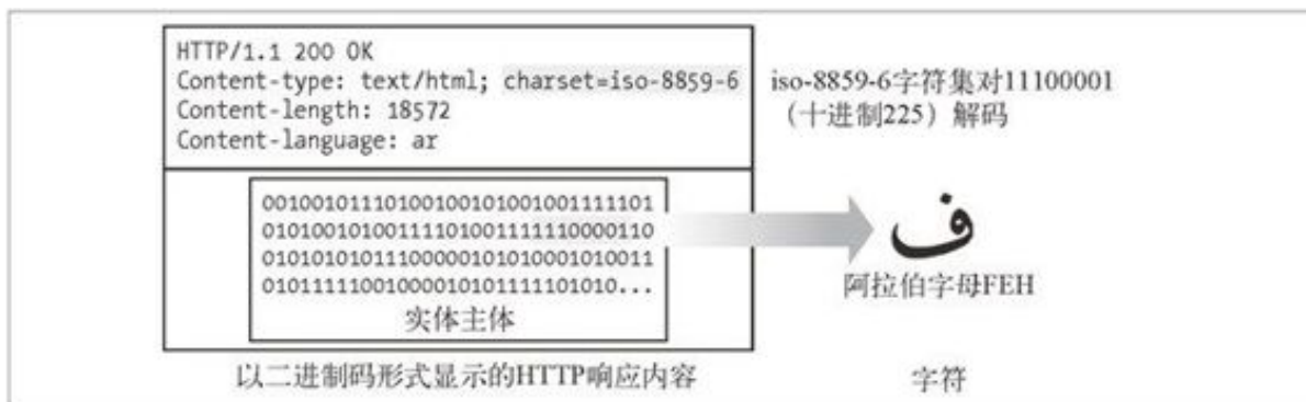
图 16-1 charset 参数告知客户端如何把内容中的二进制码转换为字符
