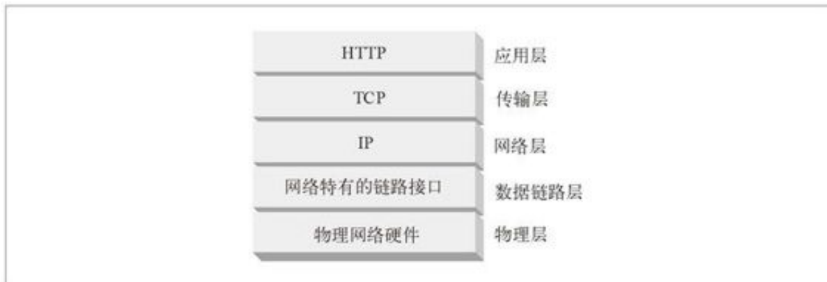
图 1-9 HTTP 网络协议栈
