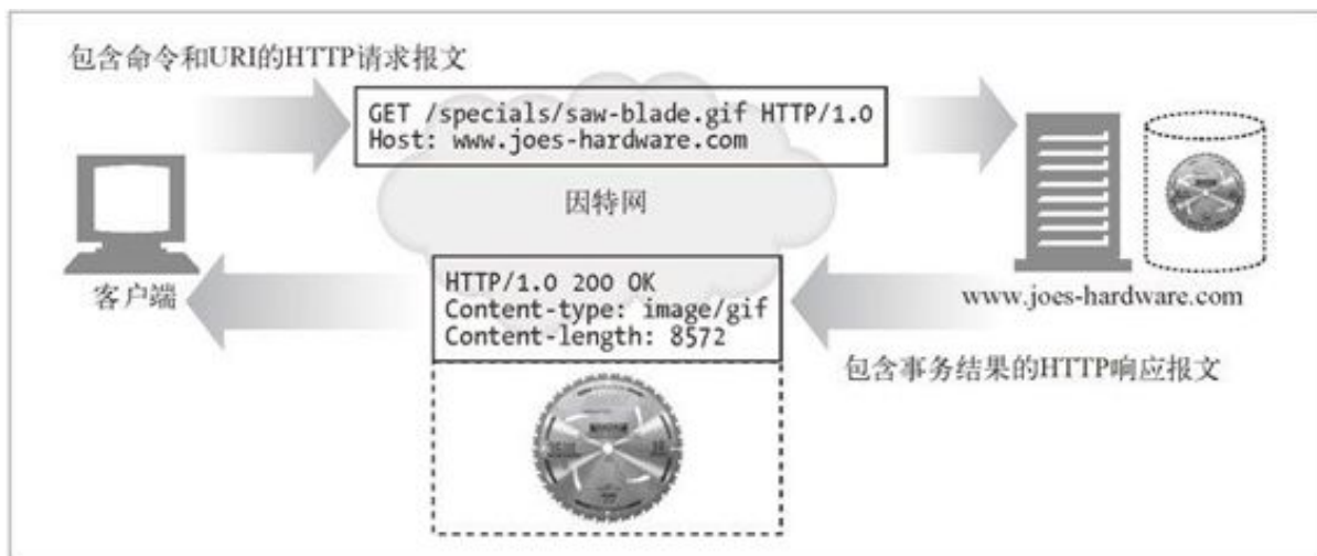
图 1-5 包含请求及响应报文的 HTTP 事务
