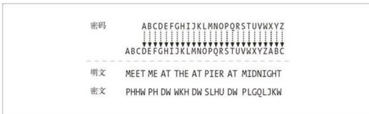
图 14-4 旋转 3 字符密码实例
