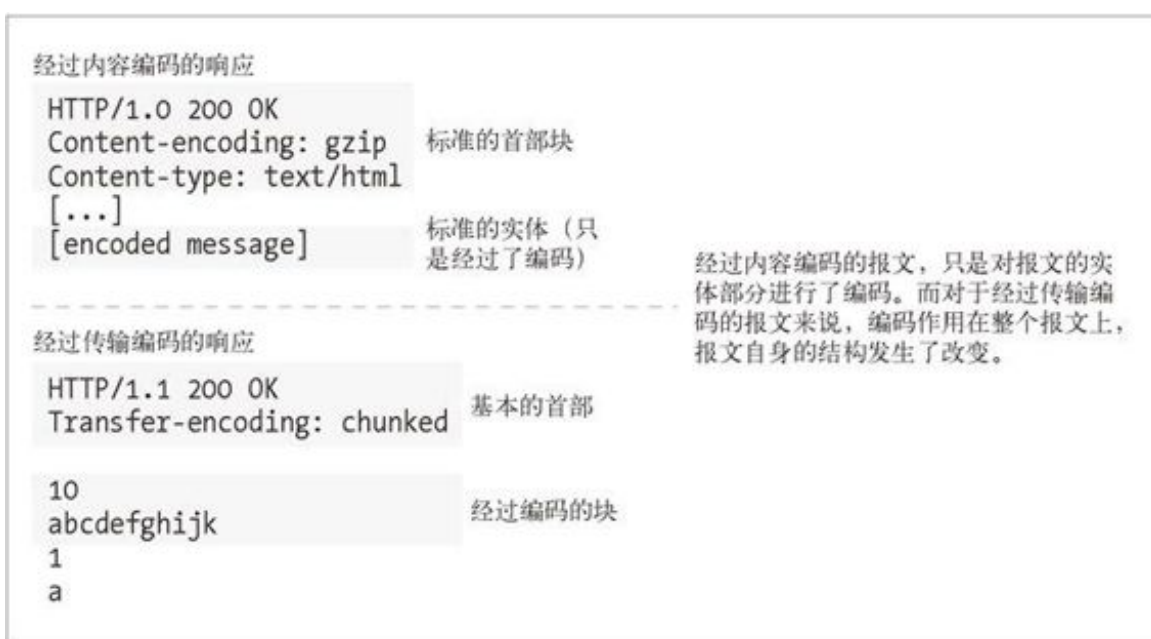
图 15-5 内容编码和传输编码的对比
