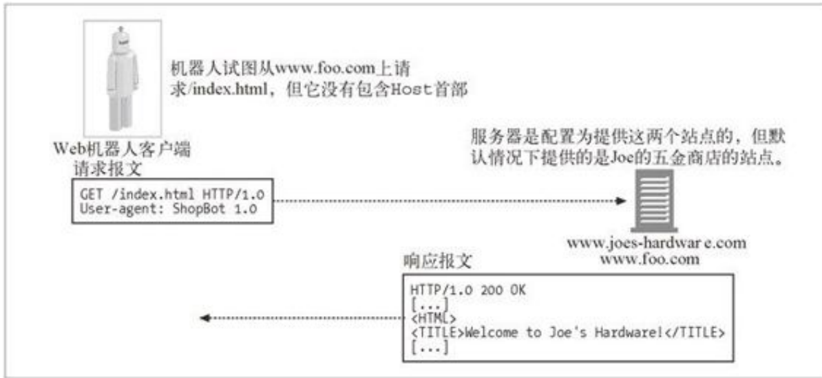
图 9-5 发送请求时没有携带 Host 首部，虚拟 docroot 会引发问题的例子
