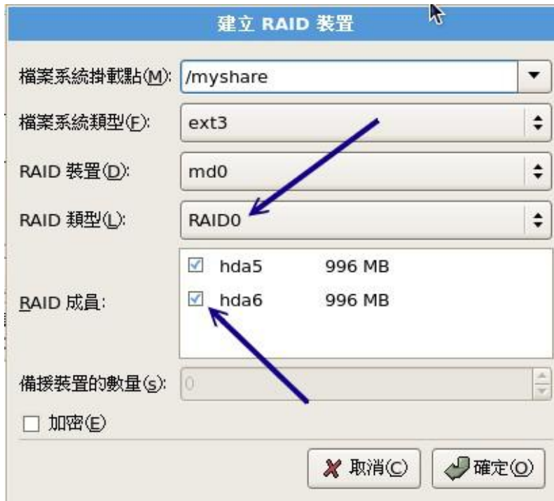
图2.4.18、软体磁碟阵列的挂载点、等级与档案系统格式
