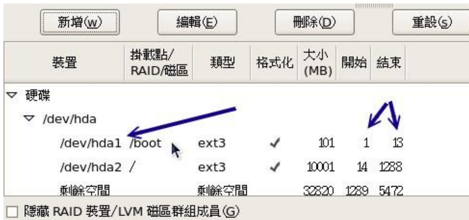
图2.4.8、/boot分割槽自动调整磁柱号码示意图
