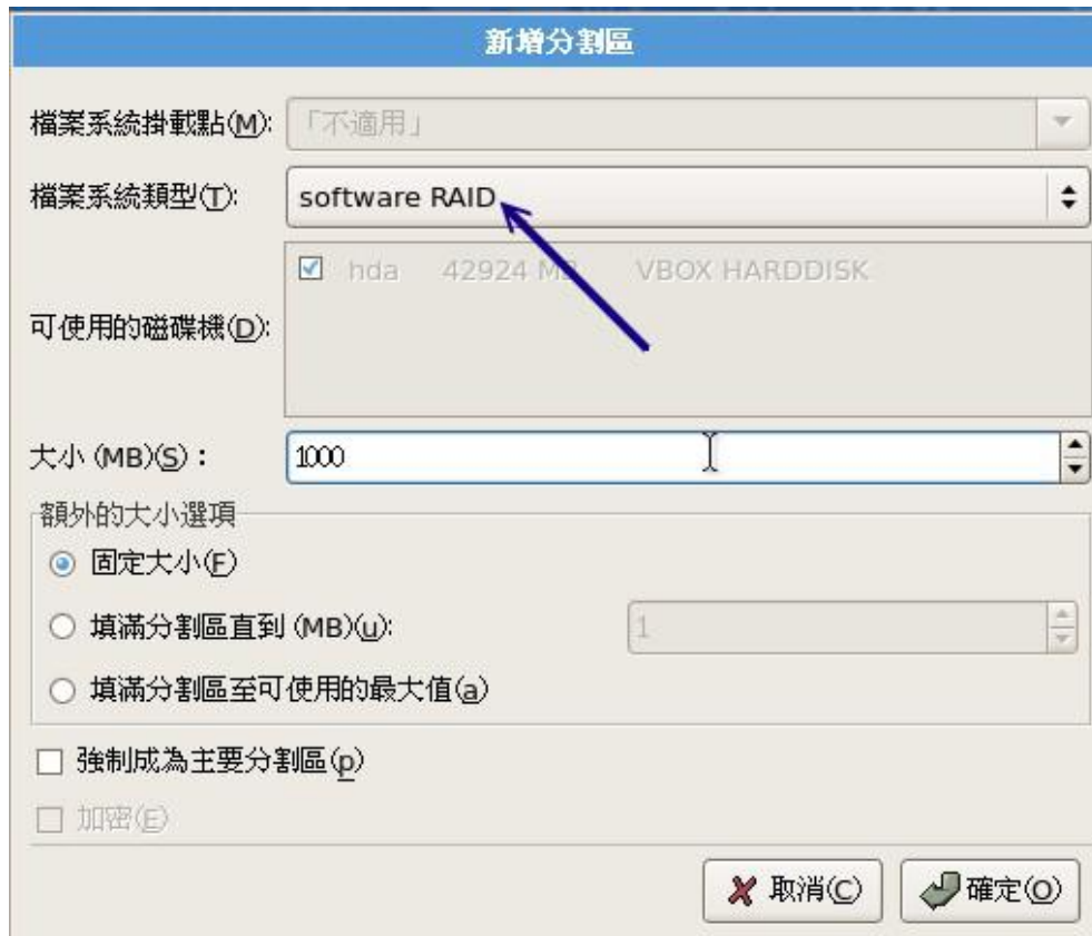
图2.4.15、软体磁碟阵列分割槽的建立示意图
