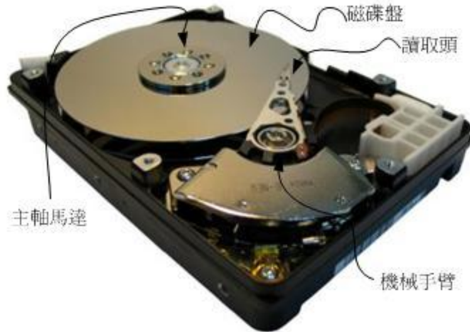
图2.4.1、硬碟物理构造(图片取自维基百科)
