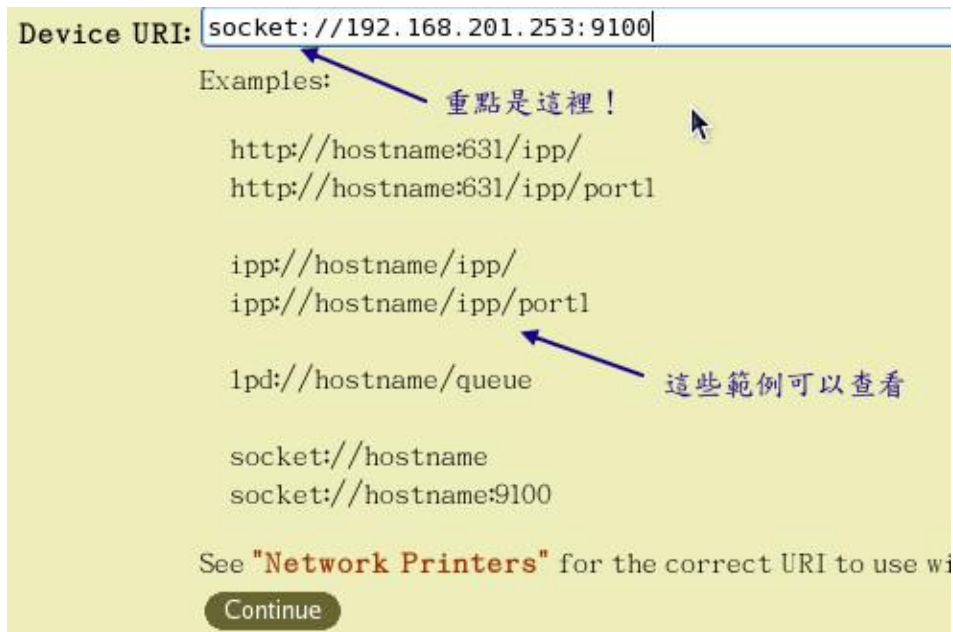
图 2.3.4、填写印表机的实际连线方式，要填正确！
