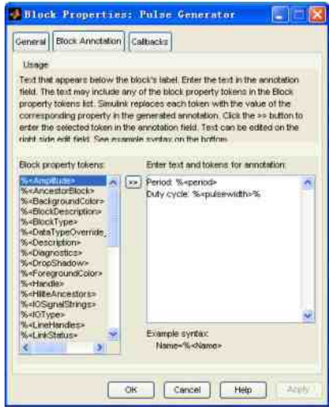
图19.69 设置模块显示的参数数值
