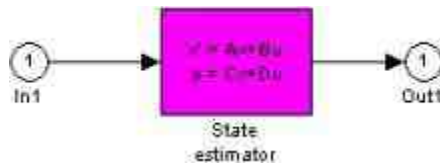
图20.22 添加“State estimator”子系统的模块
