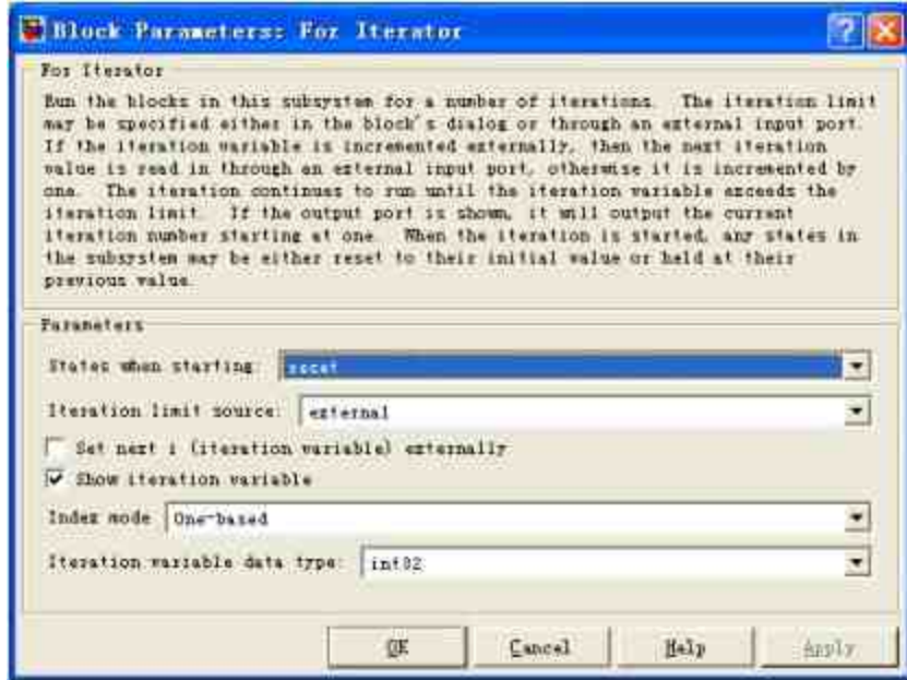
图19.57 设置“For Iterator”模块的属性
