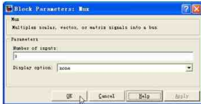
图19.35 修改“Mux”模块的输入端口
