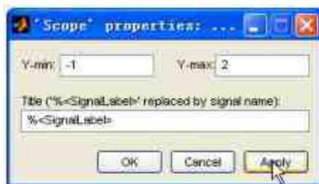
图18.118 设置Y坐标轴的上下限
