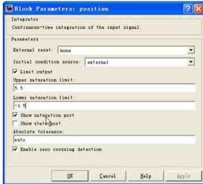
图19.46 设置“position”积分器模块的属性
