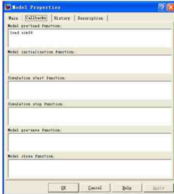
图20.29 设置系统的加载函数
