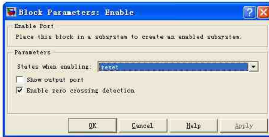
图19.112 设置“Enable”模块的属性
