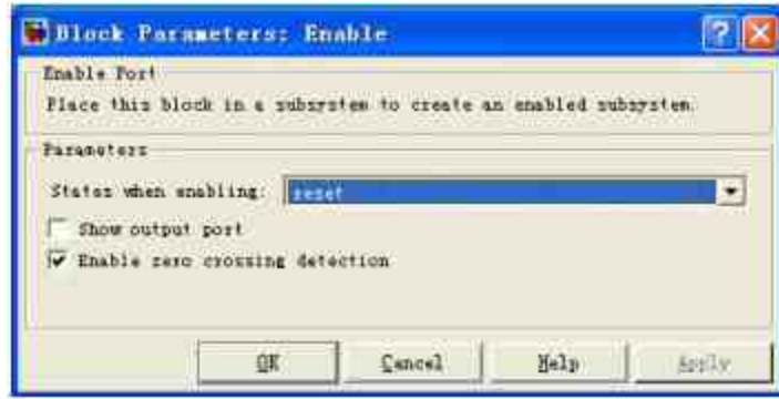
图20.54 设置“Enable”模块的属性
