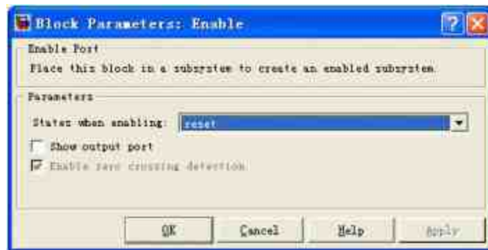
图19.120 设置“Enable”模块的属性
