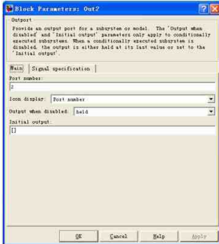
图19.122 设置输出模块2的属性
