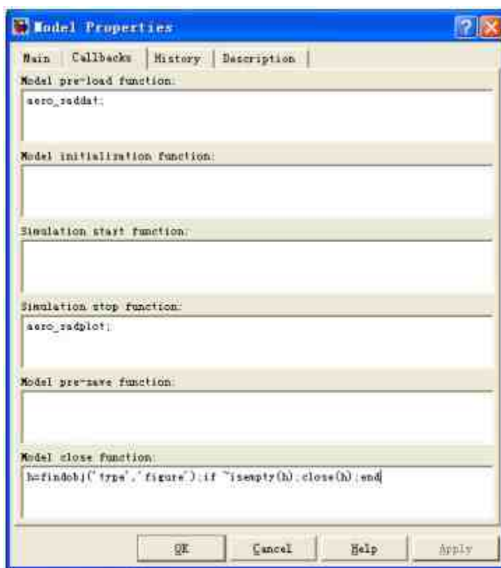
图20.80 设置系统模块的属性
