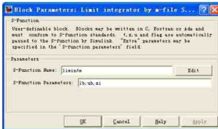
图20.11 S函数的参数设置
