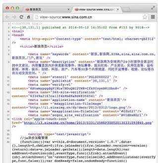
当浏览器读取到新浪首页的HTML源码后，它会解析HTML，显示页面，然后，根据HTML里面的各种链接，再发送HTTP请求给新浪服务器，拿到相应的图片、视频、Flash、JavaScript脚本、CSS等各种资源，最终显示出一个完整的页面，所以我们的Network下面能看到很多额外的HTTP请求。
