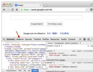
Elements显示网页的结构，Network显示浏览器和服务器的通信，我们的Network，确保第一个小红灯亮着，Chrome就会记录所有浏览器和服务器之间的通信：
