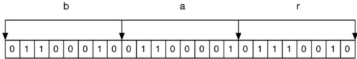
图3-3 bar 的二进制存储结构
