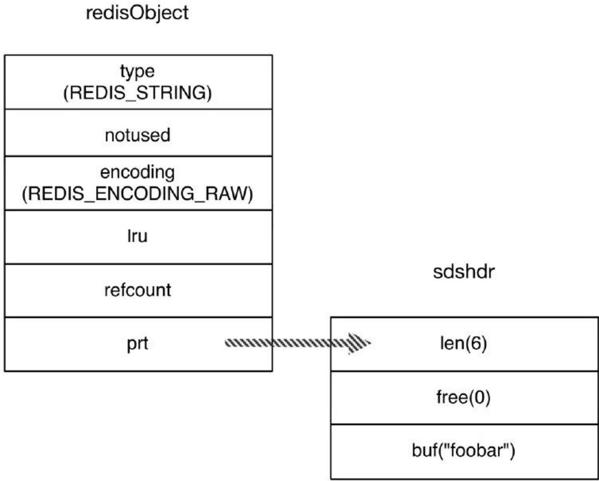
图4-4 字符串键值“foobar”的存储结构
