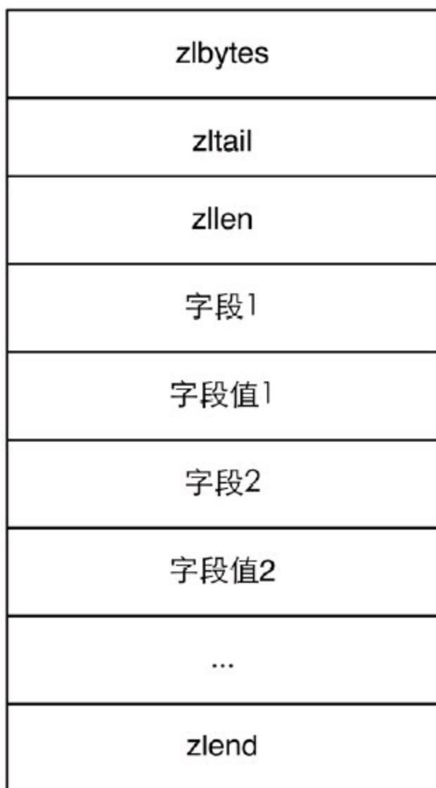
图4-8 使用REDIS\_ENCODING\_ZIPLIST编码存储散列类型的内存结构
