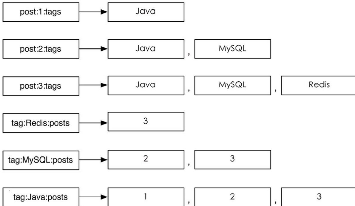
图3-18 和标签有关部分的存储结构
