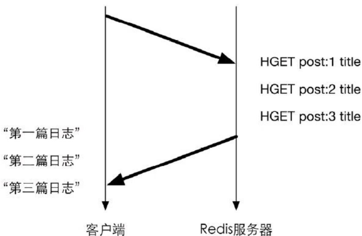
图4-3 使用管道时的命令执行示意图
