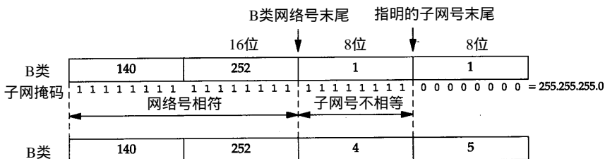
图3-8 使用子网掩码的两个B类地址之间的比较
