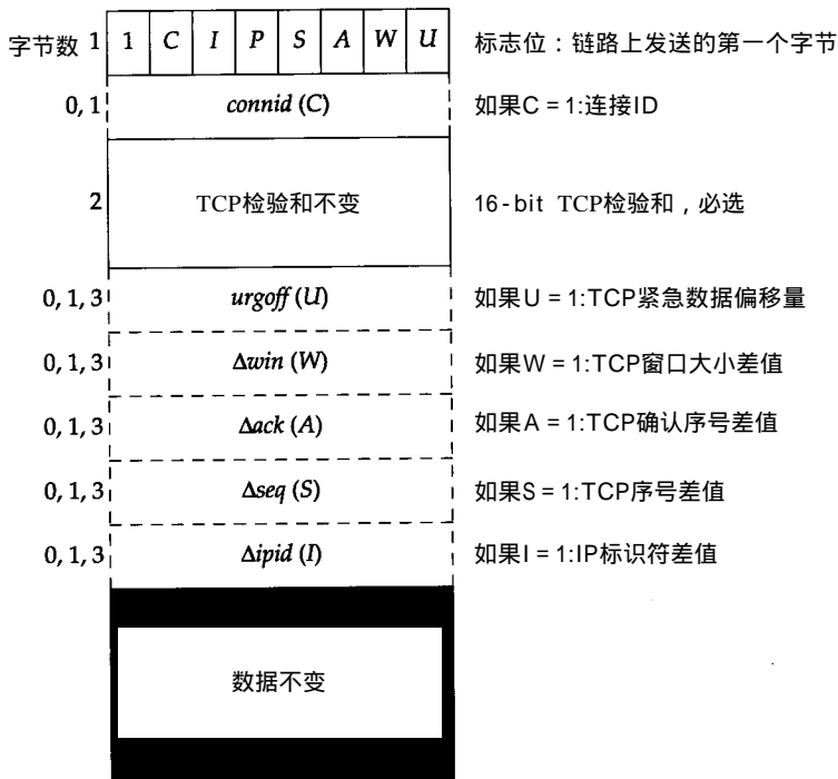
图29-34 压缩后的IP/TCP首部格式
