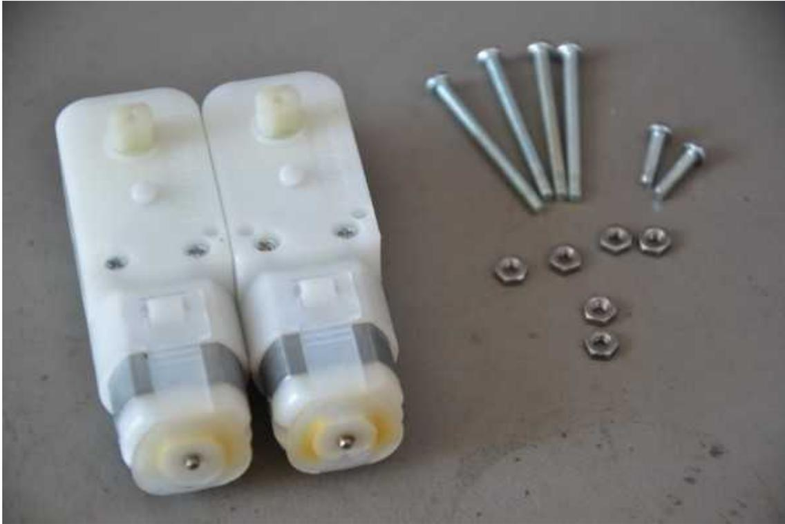
8. Setze die Schrauben von der Seite ein, wo sich die Antriebsachse befindet und auf der anderen Seite werden die Muttern aufgeschraubt. Ziehe die Muttern aber nicht fest. Nur ca. 2 Umdrehung, dass sie nur auf der Schraube drauf sind.
