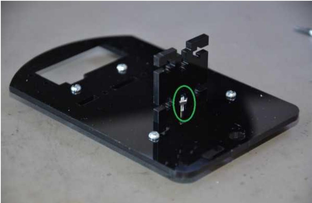
4. Nun wird die vordere Platte mit zwei M2,5×10 Schrauben und M2,5 Muttern verschraubt.
