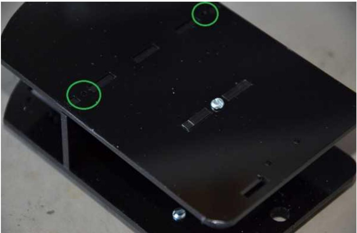
7. Jetzt werden die GM9 Motoren vorbereitet. Dazu benötigen wir noch 4 Stück M2,5×30 Schrauben, 2 Stück M2,5×10 Schrauben und 7 Stück M2,5 Muttern. Wobei die kleineren Schrauben ein paar Schritte später eingesetzt werden.
