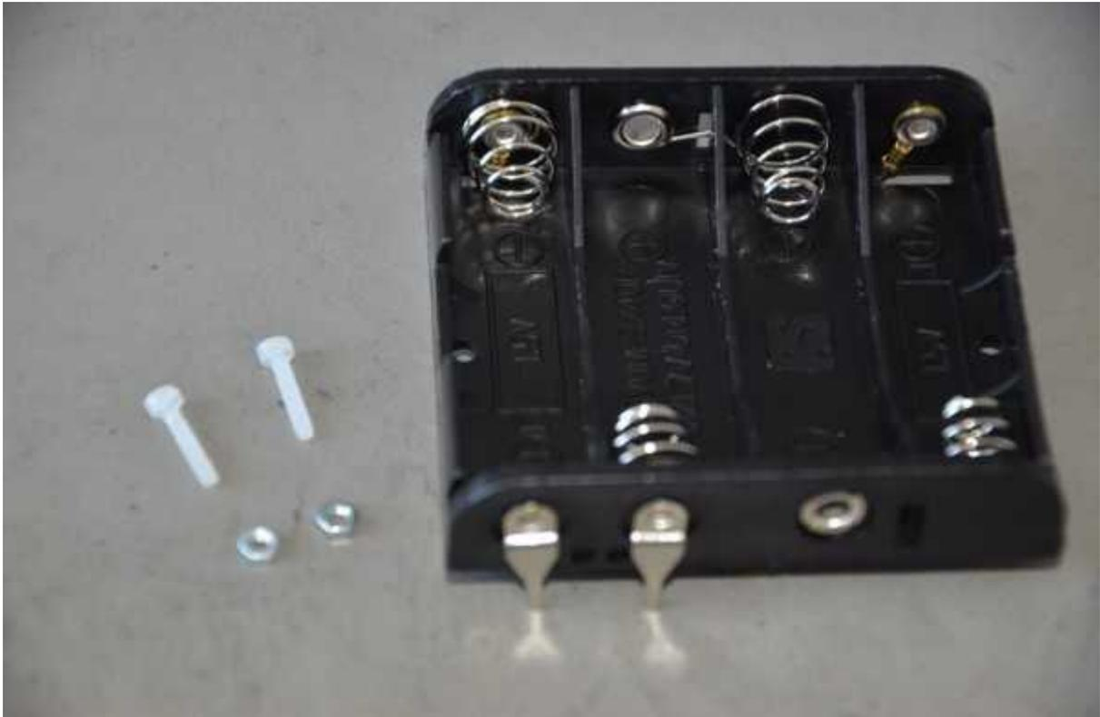
12. Wenn ein Batteriehälter, mit abstehen Lötfähnchen verwendet wird, müssen die Fähnchen erst mal um 90° gebogen werden. Dann die zwei Drähte wie auf dem Bild abisolieren und anlöten.
