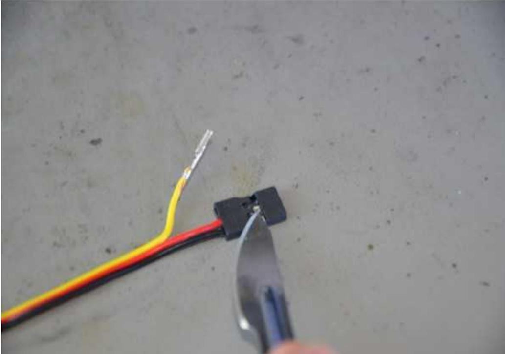
18. Nach der Aktion mit dem Steckergehäuse, müssen wir auf die Hülsen etwas Schrumpfschlauch drüber ziehen, damit kein Kurzschluss entsteht, wenn wir sie nebeneinander stecken.
