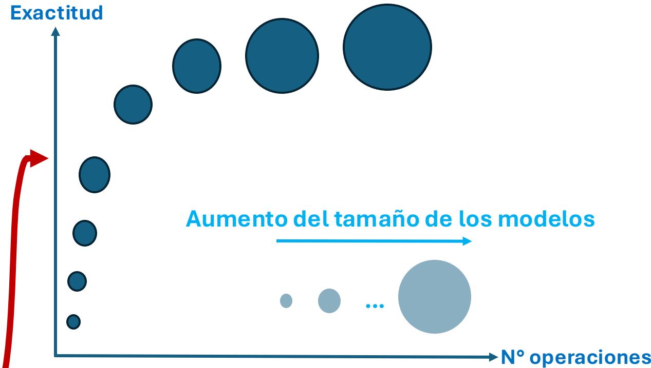
Figura – Exactitud de clasificación basada en el tamaño y el número de operaciones en coma flotante de diferentes modelos de aprendizaje profundo (inspirado en Abbas et al. 2021).
