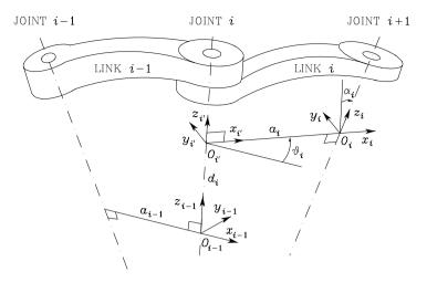
Fig. 2.16. Denavit–Hartenberg kinematic parameters
